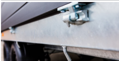
Komplett feuerverzinktem Chassis
